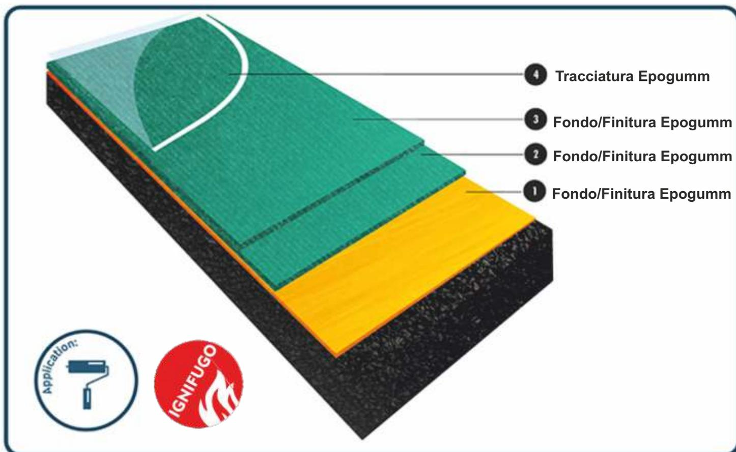
Il sistema una volta applicato raggiunge uno spessore di circa 750 microns (1,25 mm. di spessore)
