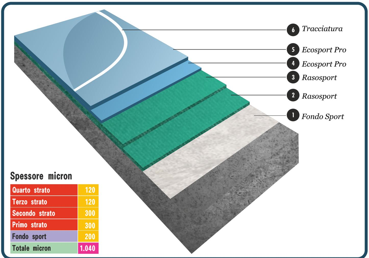
**NOTA:** le superfici in resina sono solitamente impermeabili non drenanti o con un drenaggio molto lento e richiedono un supporto con le dovute pendenze.
